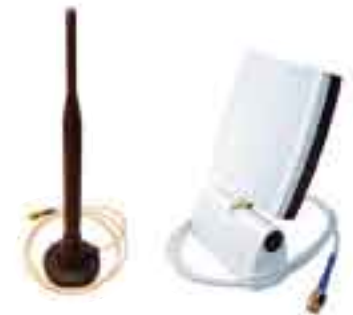
Einsatz externer Antennen für Verstärkung resp. Fokussierung Funksignal
